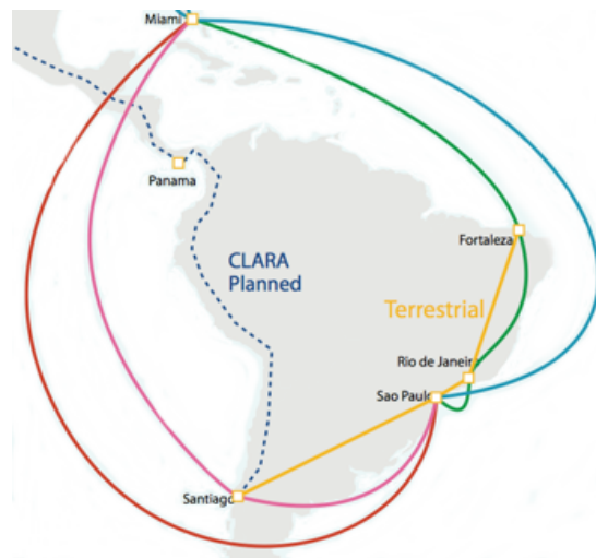
Figura 10.5. Topologia de rede da AmLight [Ibarra et al. 2015].
