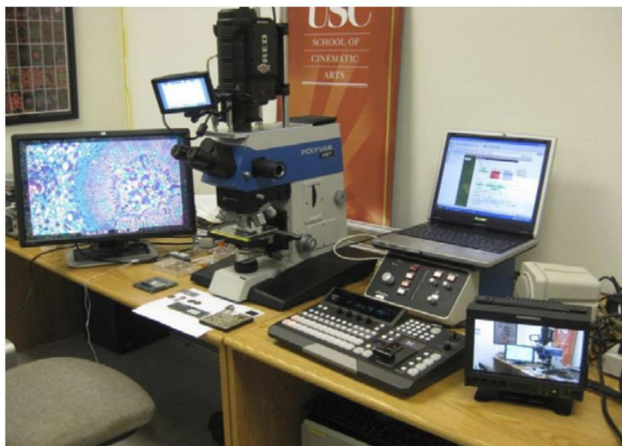
Figura 5.2 – Câmera Red One acoplada ao microscópio.
