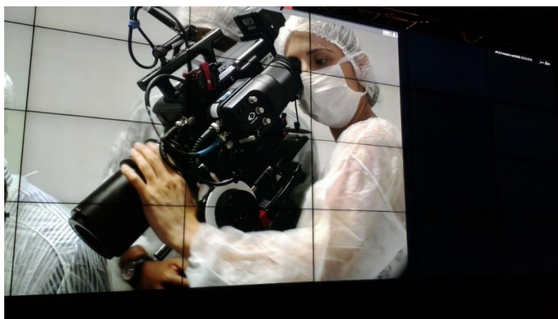
Figura 2.7 Câmera com recurso de captação de 1000 fps em 4K posicionada no centro cirúrgico do Depto. de Oftalmologia da Unifesp. (Foto: Cicero da Silva)
