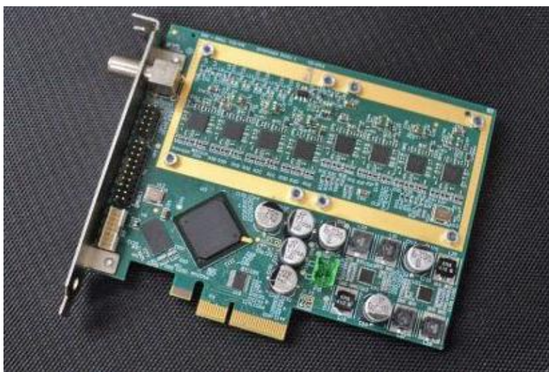
Figura 11.3. Placa OctoTuner - permite a captação e decodificação de até oito canais de TV simultaneamente
