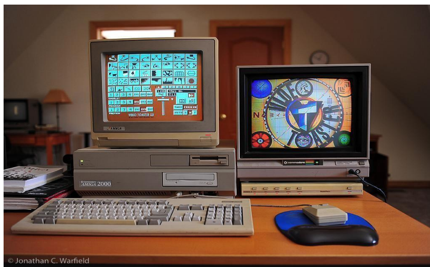
Figura 2.10 Video Toaster rodando no Computador Amiga 2000. Fonte: < https://goo.gl/iSB6YS >
