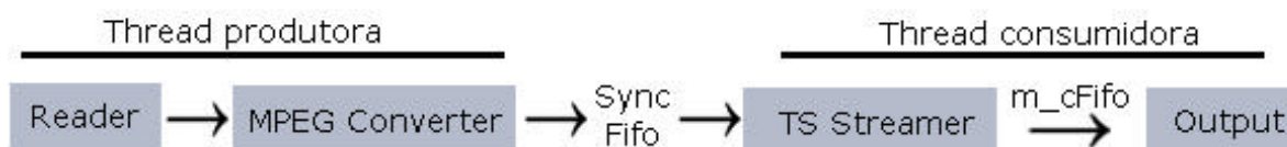
Figura 2. Arquitetura Geral do VLS.
